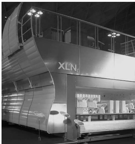
Печь с выкатным подом в керамической промышленности
